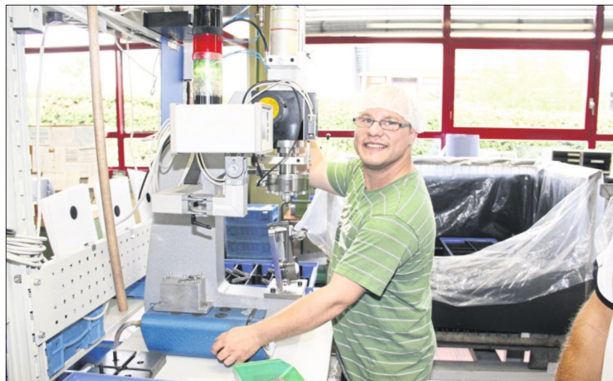
170 MENSCHEN MIT BEHINDERUNG sind bei der WdL in Sinzheim beschäftigt. Das Bild zeigt Franz Matz beim Verstemmen von Kugeln in Gehäusen für die Firma Schaeffler. Foto: pr
